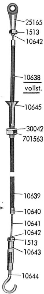
**Ergänzungsteile zur Befestigung des Stoffdrückerfußes durch Fußtritt
